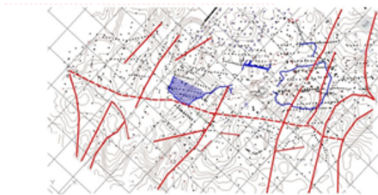
Рисунок 1 – Схема разломов территории шахты «Абайская», установленных методом структурной морфометрии
