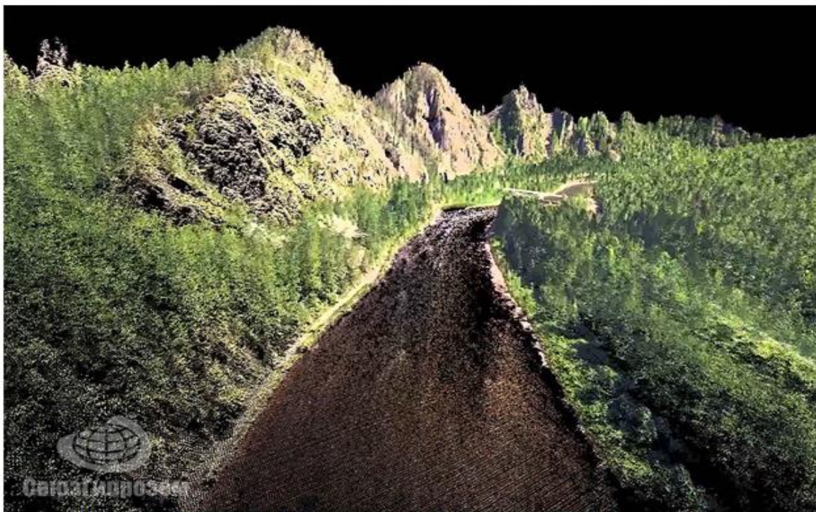
Рис.3 Облако точек воздушного лазерного сканирования
