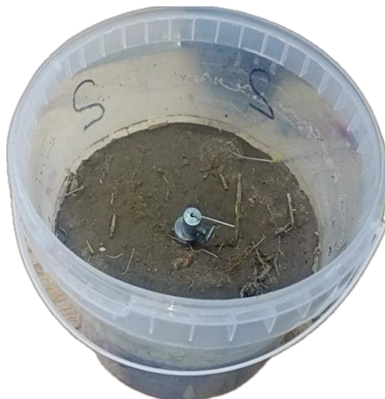
Рисунок 8 – Погружение измерительного конуса в почвенный образец
