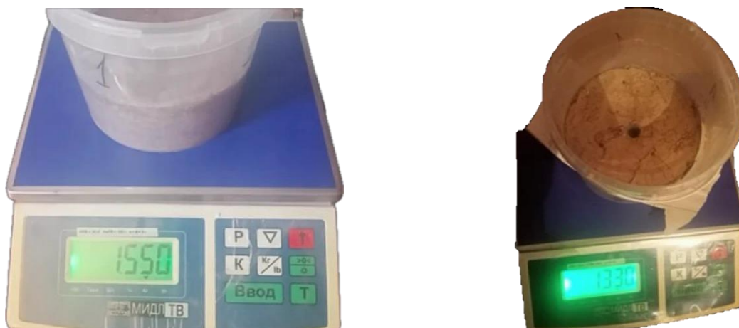
Рисунок 9 – Определение влажности почвенного образца с использованием электронных весов
