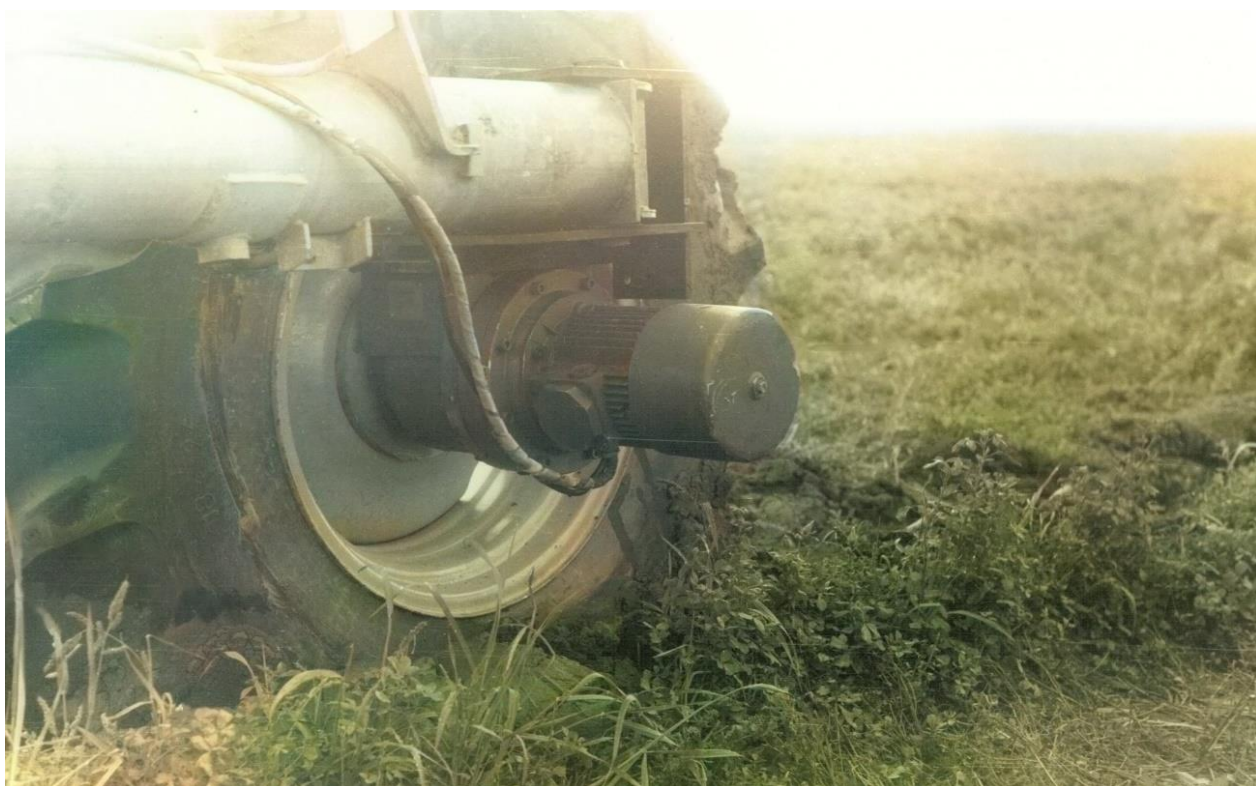
Рисунок 3 – Тележка ДМ «Кубань-ЛК1» с энергосберегающим независимым электроприводом
