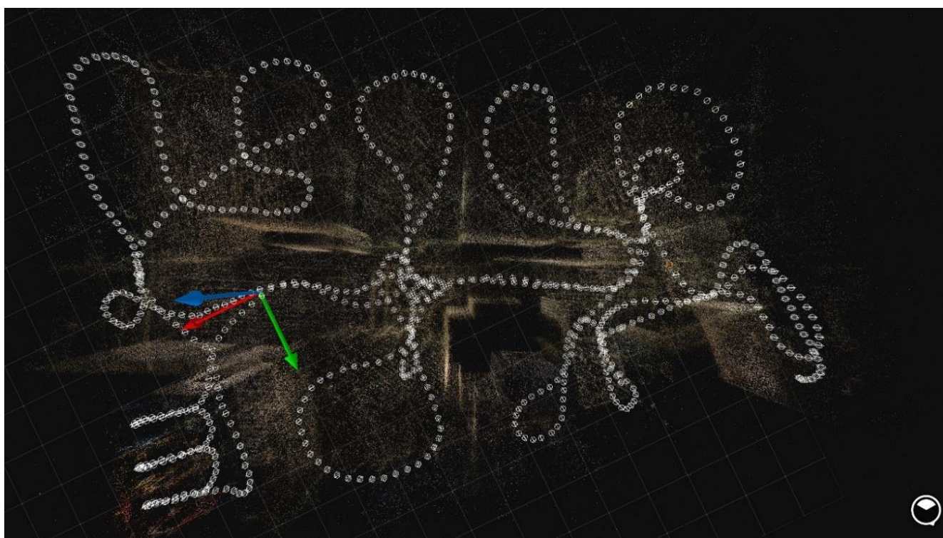
Рисунок 3. Восстановление траектории движения в изолированном пространстве
