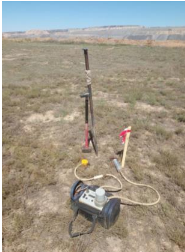
Рисунок 1 – Радиометр альфа-активных газов РГА-500
