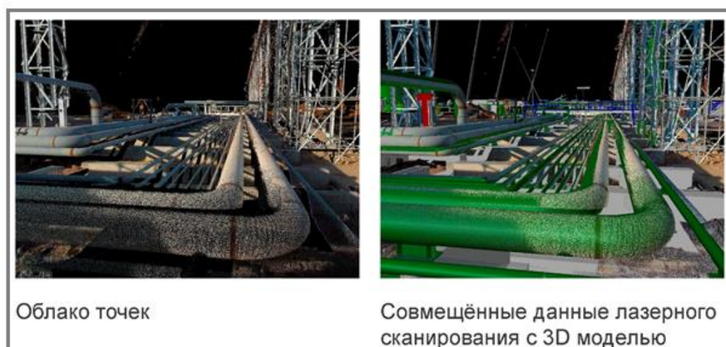
Рисунок 4 – Сравнение отсканированного трубопровода с ее проектной 3D моделью.
