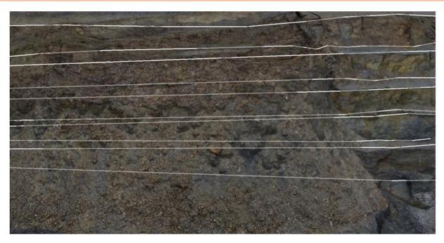
\* белые линии отображают положение уступов до обрушения.
