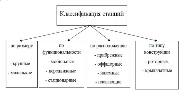
Рис.1. Классификация ветроэлектростанций
