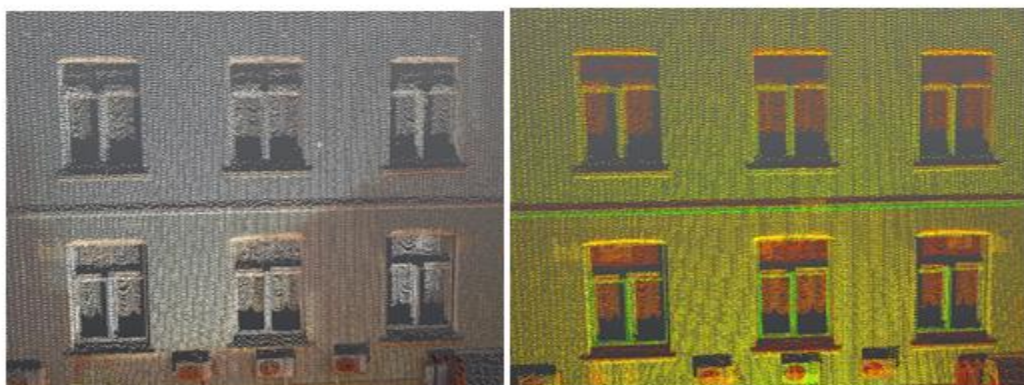
Рисунок 2. Фрагмент облака точек фасада здания, отображение в натуральном цвете и по интенсивности отраженного сигнала
