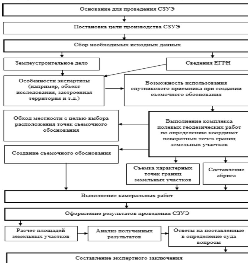
Рисунок 4. Технологическая схема комплекса инженерно-геодезических работ для проведения СЗУЭ
