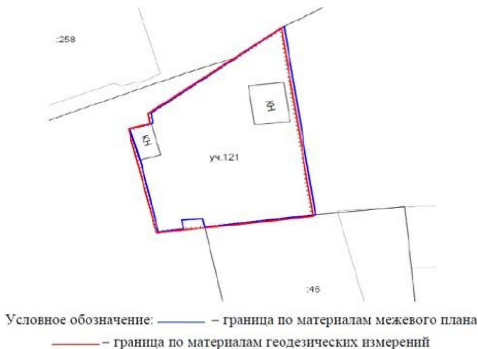
Рисунок 1. Результат геодезических измерений
