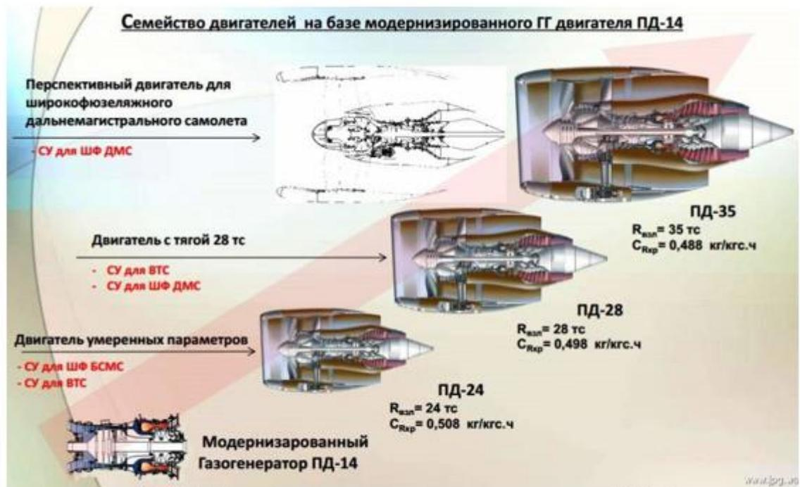
**Рис. 1. Семейство перспективных двигателей ПД на базе газогенератора ПД-14**
