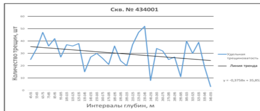
Рисунок 3. Зависимость встречаемости трещин по глубине скважины № 434001
