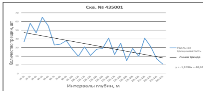
Рисунок 1. Зависимость встречаемости трещин по глубине скважины № 435001
