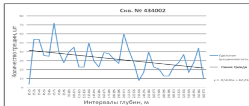
Рисунок 4. Зависимость встречаемости трещин по глубине скважины № 434002
