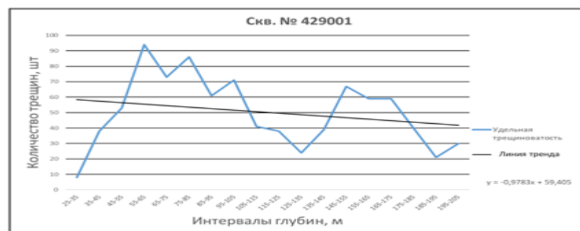
Рисунок 8. Зависимость встречаемости трещин по глубине скважины № 429001
