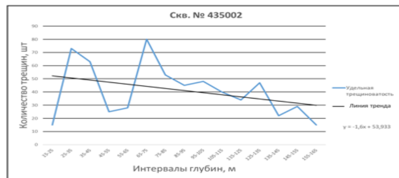
Рисунок 2. Зависимость встречаемости трещин по глубине скважины № 435002
