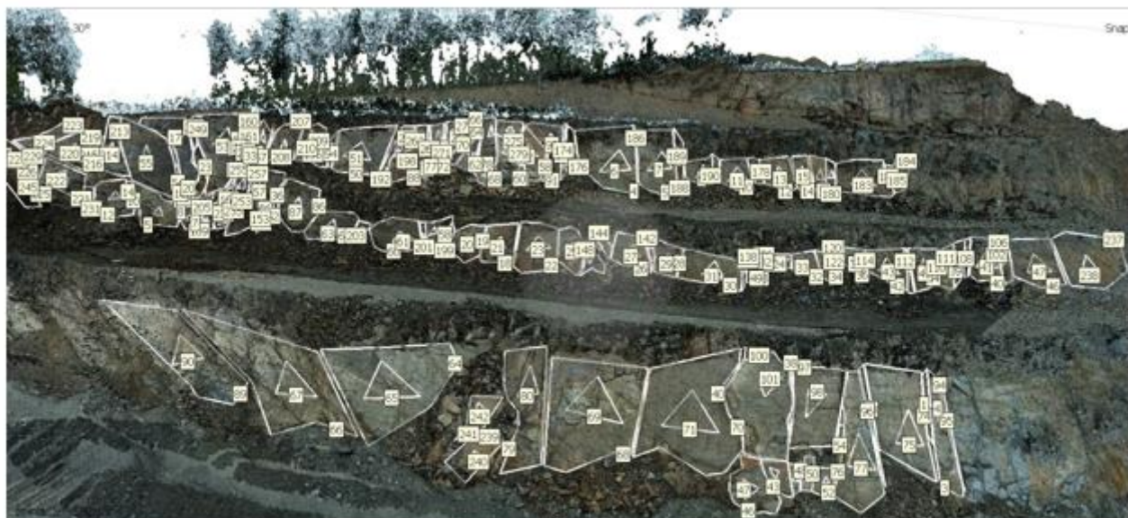
Рисунок 3. Выделение плоскостей трещиноватости (на участке борта карьера)
