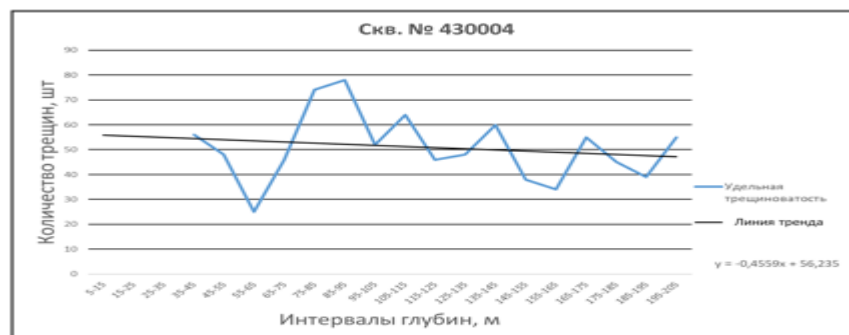
Рисунок 7. Зависимость встречаемости трещин по глубине скважины № 430004
