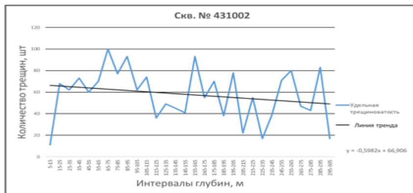
Рисунок 6. Зависимость встречаемости трещин по глубине скважины № 431002
