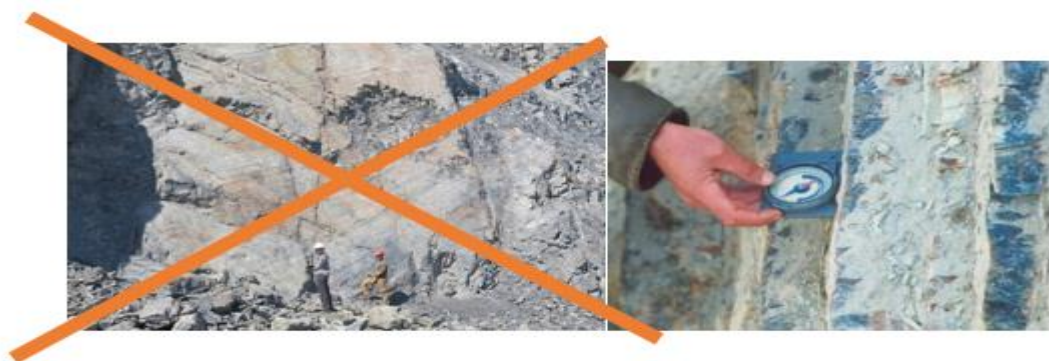
Рисунок 1. Съёмка трещиноватости классическими способом
