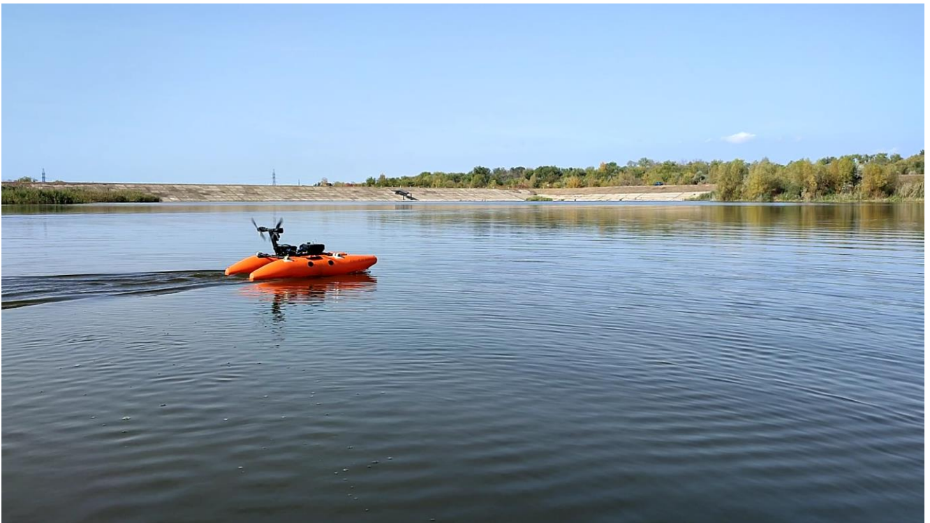
Рисунок 1 – Беспилотный роботизированный гидрографический комплекс при выполнении промеров глубин на водохранилище на овраге Мечетка, октябрь 2023 г.
