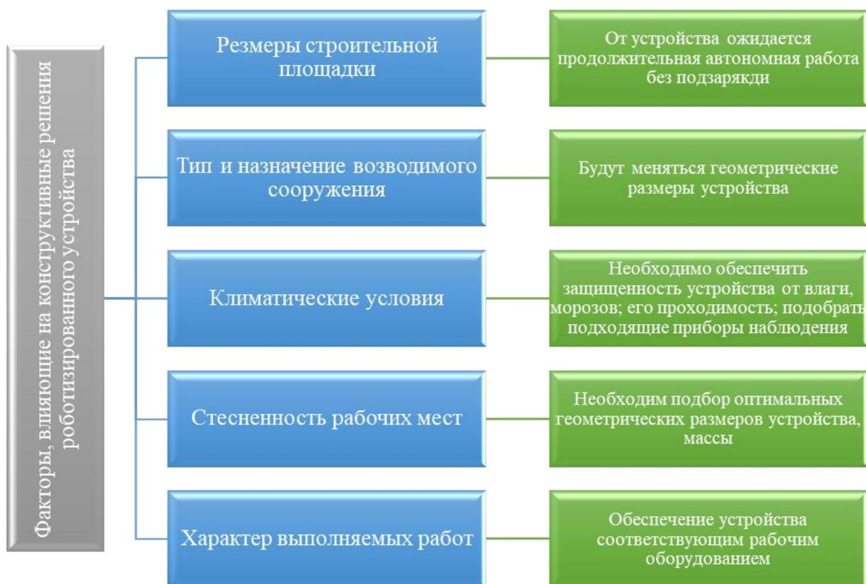
**Рисунок 1. Зависимость конструктивных решений робота в зависимости от условий его работы**
