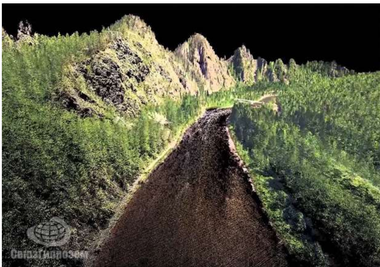
Рис.3 Облако точек воздушного лазерного сканирования
