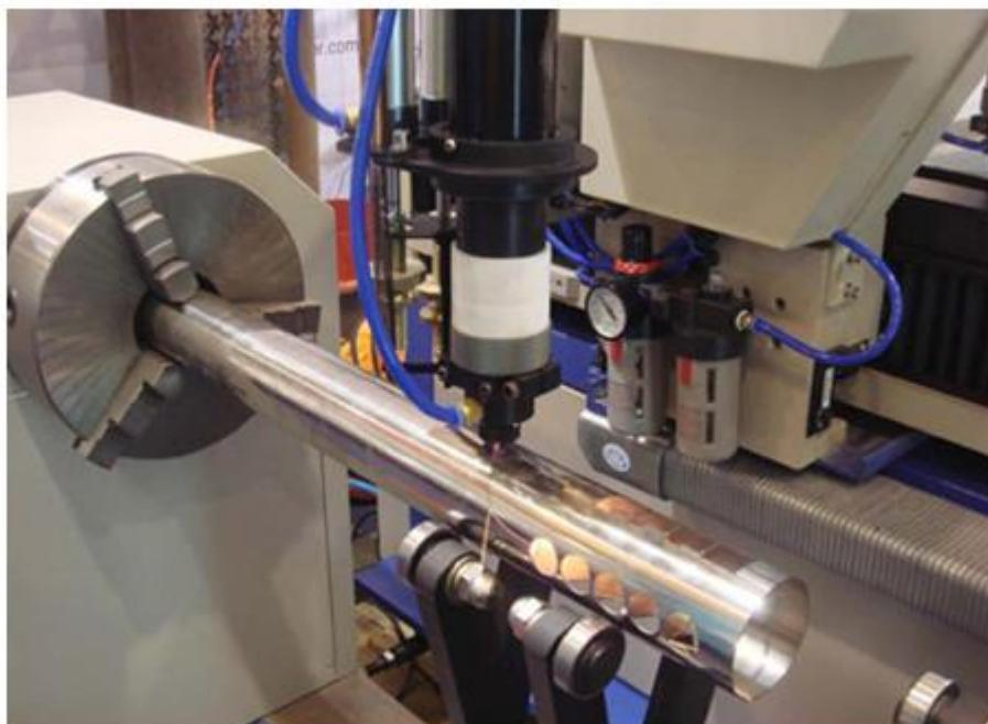
Рисунок 2 – Оборудование для лазерной резки и гравировки металла
