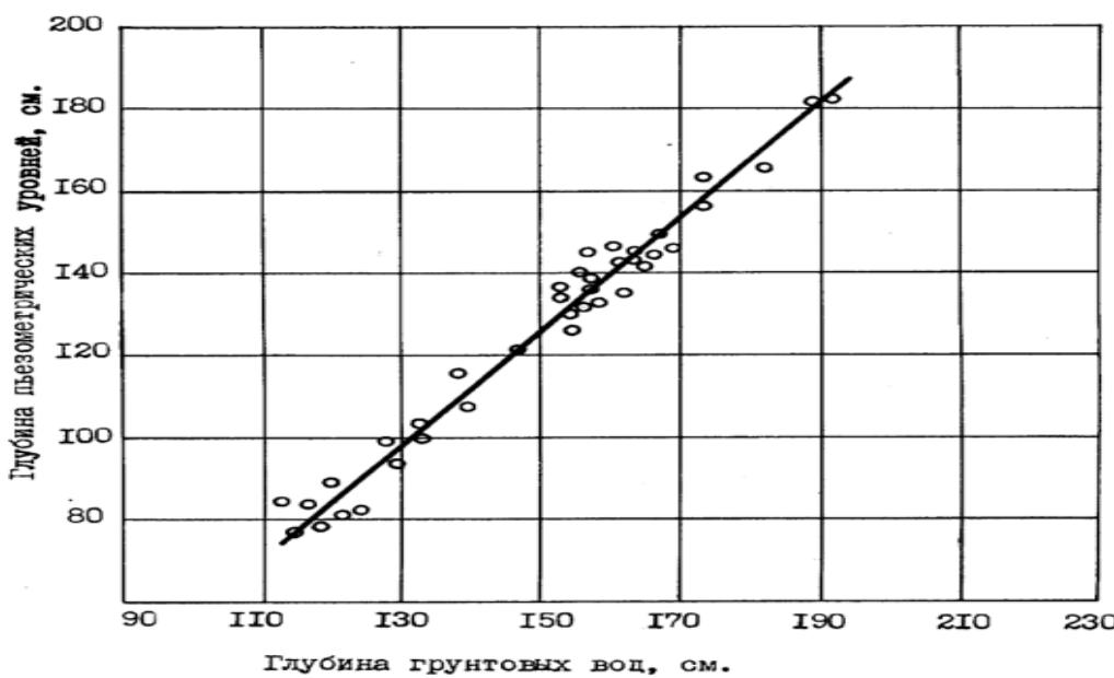
Рис. 1 Связь между глубиной залегания грунтовых вод и пьезометрических уровней на площади осушаемой дренажными системами с параметрами  $H=1,8$  м,  $B=10$  м.
