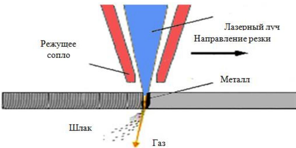
Рисунок 1 – Сущность процесса лазерной резки металла
